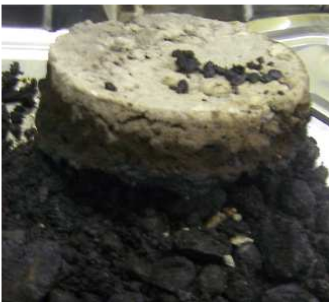
Asfalto dopo combustione
